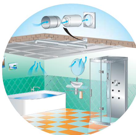
VKO1 fan flat ventilation example
