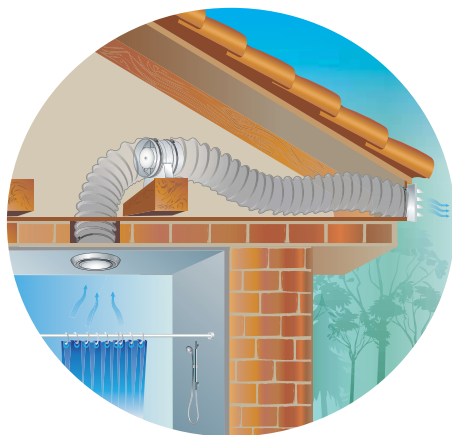
VKO1 fan cottage ventilation example
