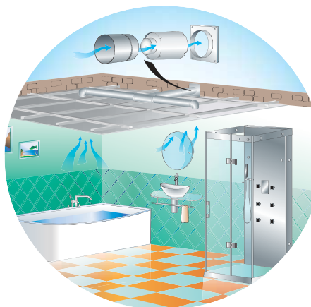
VKO1 fan flat ventilation example
